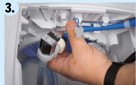
3. Frischwasserschlauch abschrauben, Strom und Frischwasserschlauch von Pumpe trennen.
